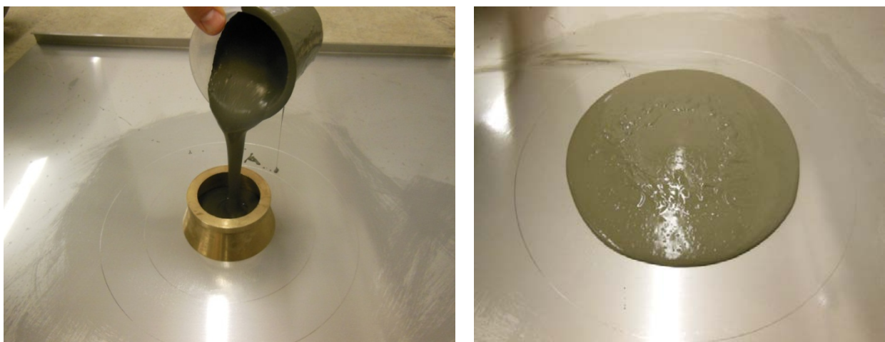
Figure 3.5 Mini slump test
